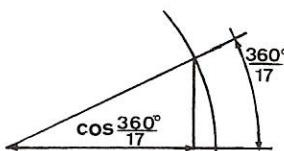
Résoudre le problème revient à montrer que l'on peut construire avec la seule aide d'une règle et d'un compas, la valeur de  $\cos \frac{360^\circ}{17}$ . Gauss pose le problème dans le champ des complexes.
