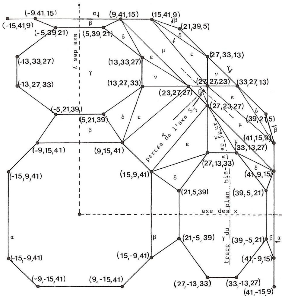
d'un axe de symétrie 3 partant du centre de la face (23,27,27), (27,27,23), (27,23,27) vers le centre de la sphère. Les plans bissecteurs de ces dièdres de  $120^\circ$  sont aussi des plans de symétrie du polyèdre. Ainsi, la recherche des faces ne doit effectivement avoir lieu que pour  $1/48$  de la sphère! ( $48 = 8 \times 3 \times 2 : 8$ : plans de symétrie comprenant les axes ; 3: axe de symétrie de  $120^\circ$ ; 2: plan bissecteur de cette symétrie).
