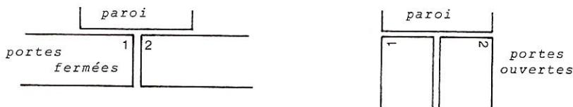
Sur de pareilles armoires, on constate que les tranches de deux portes sont très proches en position fermée. Cette proximité interdit l'usage de charnières traditionnelles par suite du manque de place pour "manoeuvrer" la porte. Pour ouvrir de telles portes, le principe est d'effectuer d'abord une translation le long du bord de l'armoire, puis ensuite la rotation pourra avoir lieu.
