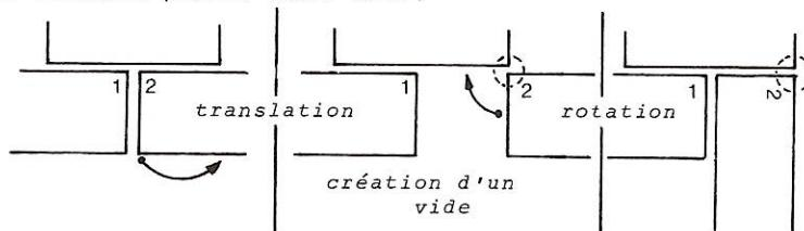
Cette vision théorique du mouvement à effectuer peut être réalisée par une charnière dite "à quatre points d'ancre". ABCD est un quadrilatère dont les côtés sont indéformables; C et D sont fixés à la paroi, et A et B à la porte.
