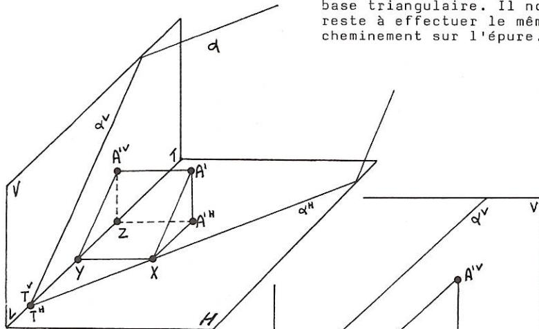
Nous voilà capable de construire la projection sur V de la section prismatique, mais cette "coupe" n'est pas vue en vraie grandeur puisque les traces de  $\alpha$  montrent que le plan n'est ni frontal, ni horizontal. Le rabattement peut s'effectuer autour de n'importe quelle horizontale du plan  $\alpha$  : par commodité, nous choisissons  $\alpha^H$ .
