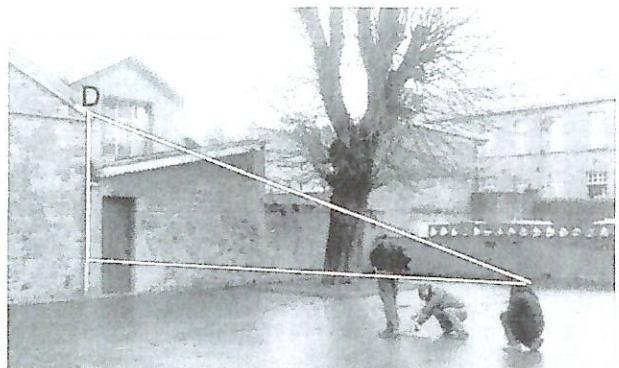
On mesure la taille de l'élève debout, la hauteur des yeux de l'observatrice, la distance entre les deux élèves, et la base du triangle.
