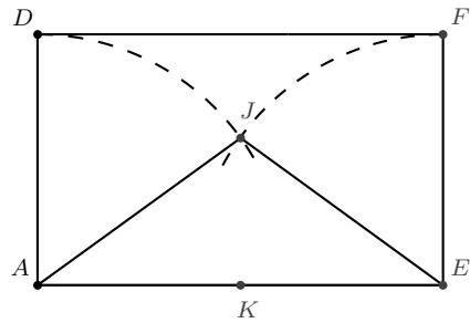
Le triangle isocèle  $AEJ$  est une représentation de l'*équerre d'argent*. C'est elle qui permet le tracé d'un pentagone régulier.
