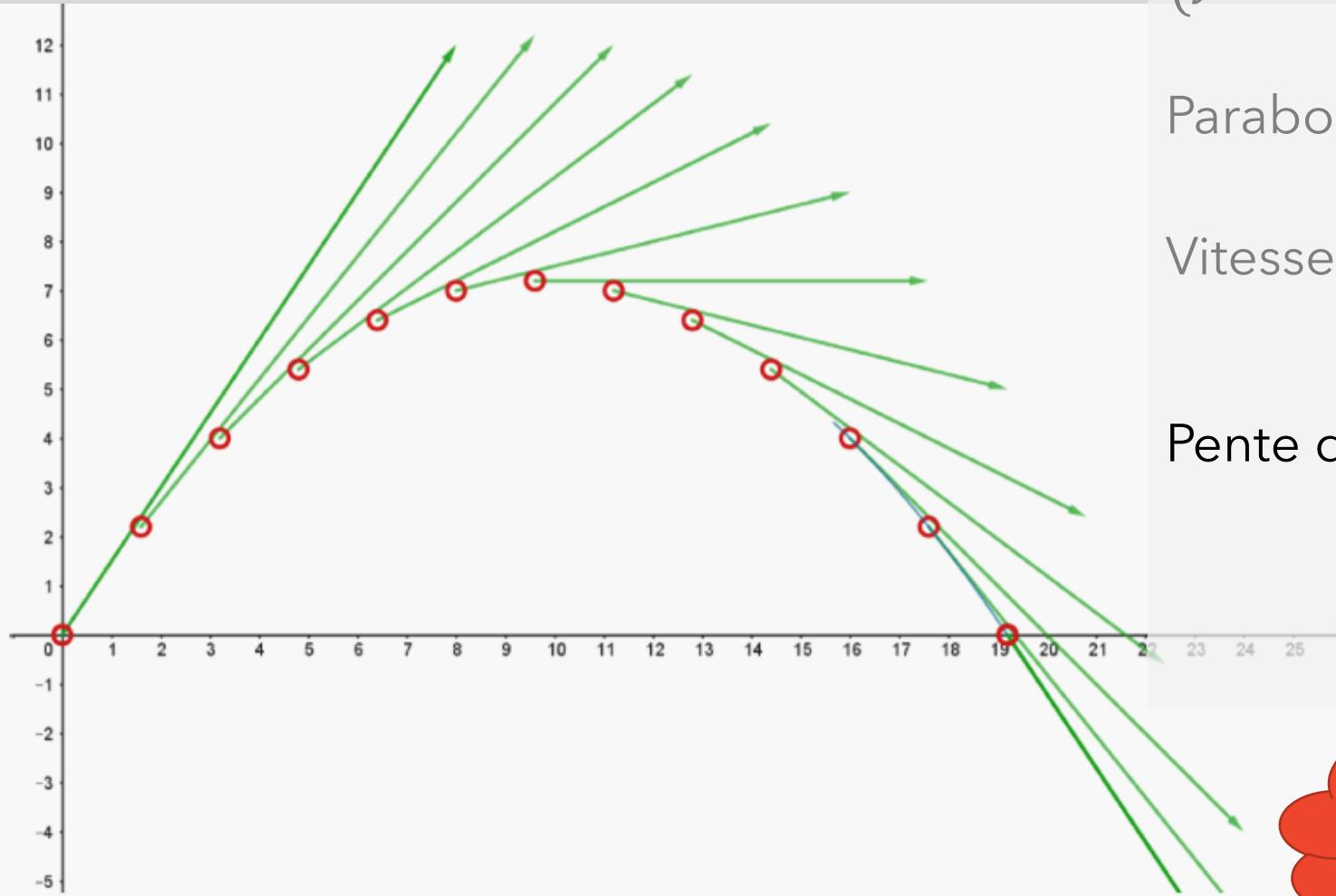
$$\begin{cases} x = 8t \\ y = 12t - 5t^2 \end{cases} \quad (t \text{ en s.; } x, y \text{ en m})$$
