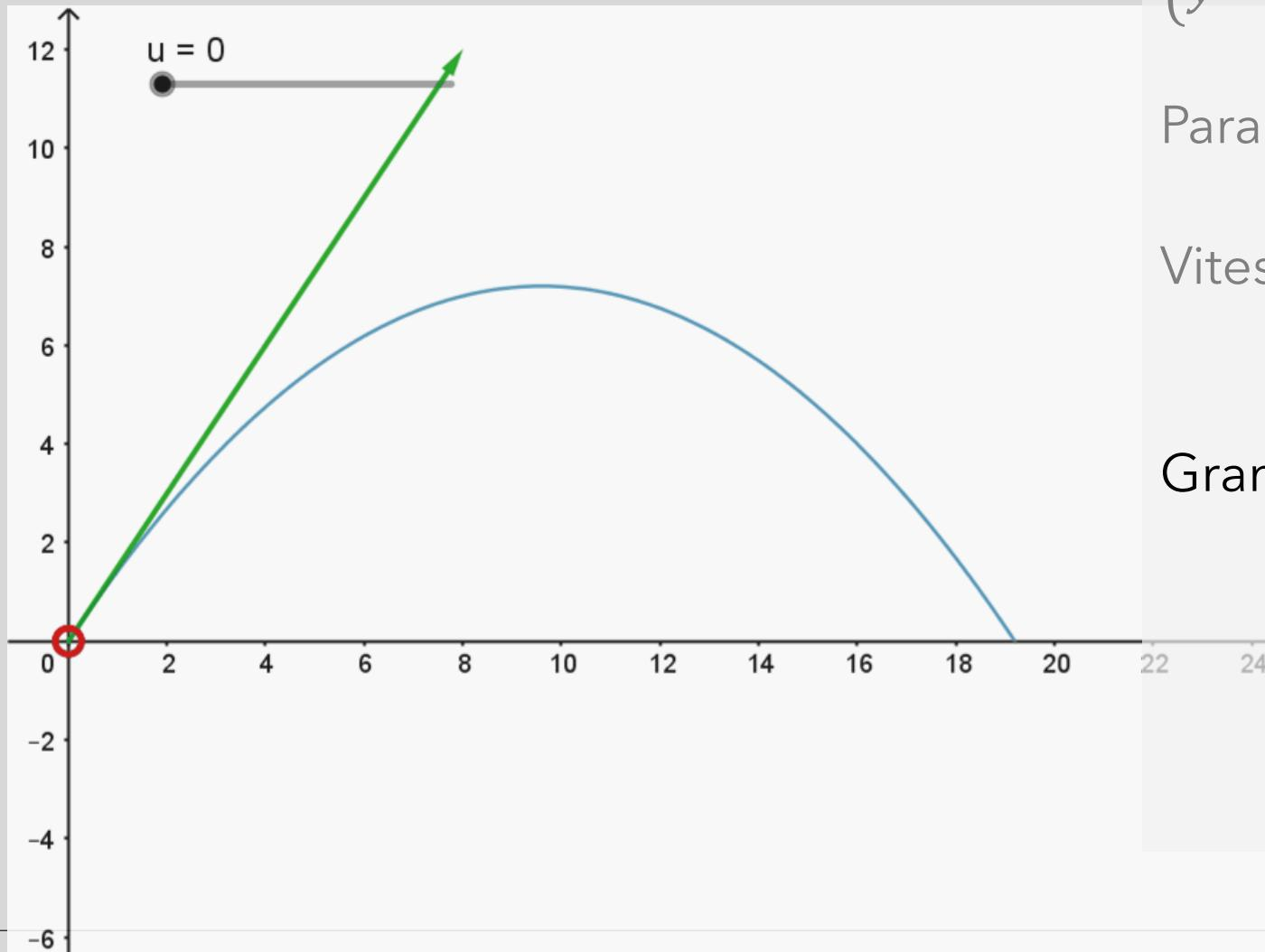
$$\begin{cases} x = 8t \\ y = 12t - 5t^2 \end{cases} \quad (t \text{ en s.; } x, y \text{ en m})$$
